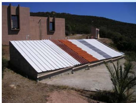
Prutotippu P3 (40m 2 ) tetti attivi per a cundensazione di u vapore d'acqua è a climatizzazione passiva di i casali da l'utilizzazione di e tinte radiattive brivettate (laboratoriu Univ. Di Corsica- Aiacciu)
