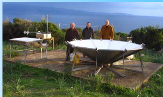
Daniel BEYSENS, Owen Clus Marc Muselli- struttura conica di cundensazione di vapore d'acqua di una aghja attiva di 7,3 m 2 (laboratoriu Univ. Di Corsica- Aiacciu)
